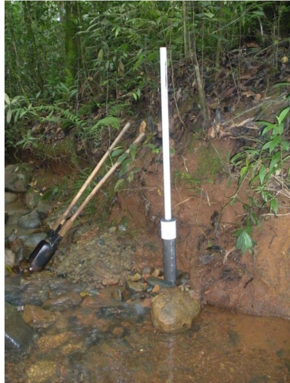
Foto 2. Tubos instalados para el montaje del limnógrafo
